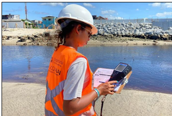
Figura 42. Obtenção in situ dos parâmetros físico-químicos da água superficial com a utilização de um analisador multiparâmetros da marca Horiba.
