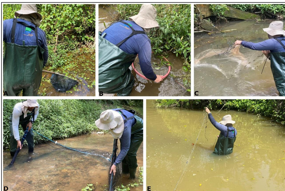
Figura 39. Aparatos utilizados para captura da ictiofauna: puça (A); peneira (B); tarrafa (C); rede de arrasto manual (D); rede de emalhar (E).
